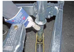
Mechanik der Feststellbremse ölen
