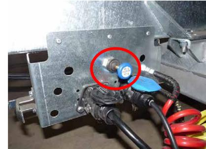
Ist der Druck im System noch > 5 bar, ist die Bremse bei gedrücktem Knopf offen und fahrbereit.
