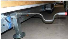
Das Fahrzeug muss gleichmäßig, durch abwechselndes Drehen an den Stützen mit nur geringem Höhenunterschied, angehoben werden, bis es ausnivelliert ist.
