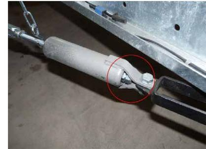
Bei angezogener Feststellbremse ist die Mutter auf dem Bremsgestänge komplett im Federspeicher verschwunden.
