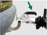
**4. Schließen der Kugelkupplung mit dem Handgriff**
