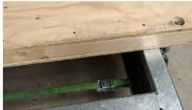
Zurrgurte an den Ringmüttern einhängen und unter dem Fahrgestell durchfädeln/durchziehen. Achten Sie darauf, keine beweglichen Teile, wie Bremsgestänge, Kabel, Schläuche etc., einzuquetschen.
