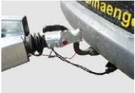
**7. Spannungsversorgung anschließen**
