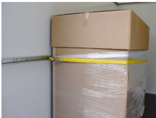
Ladungssicherung mithilfe eines Spanngurts
