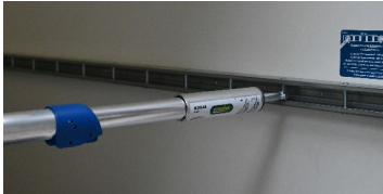
Ladungssicherung mithilfe einer Sperrstange
