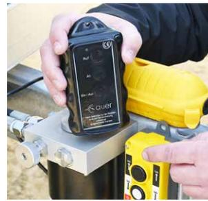
Hydraulik-Steuerung mit **Funkfernbedienung** inkl. Y-Kabel für parallele Nutzung von Kabelfernbedienung & Funkfernbedienung
