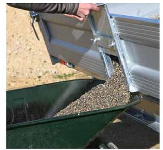
**Kornschieber** in der Heckbordwand für dosiertes Abladen
