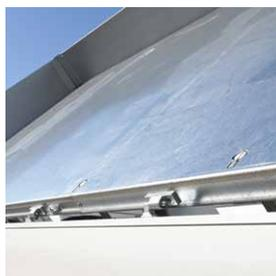
Durchgehender Stahlboden über die gesamte Fahrzeugbreite, Schmutz kann sich nicht an der Ladekante absetzen
