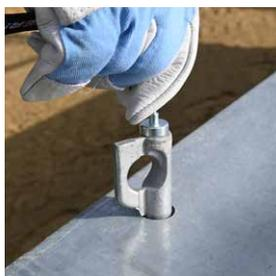
Patentiertes Ladungssicherungssystem Spinlock mit Topfmagnet, Zurrpins jeweils mit bis zu 1.500 daN (kg) belastbar
