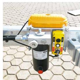
E-Hydraulik mit Notpumpe Pumpless inkl. Steckschlüsseinsatz für einfaches und bequemes Kippen mit dem Akkuschauber im Notfall
